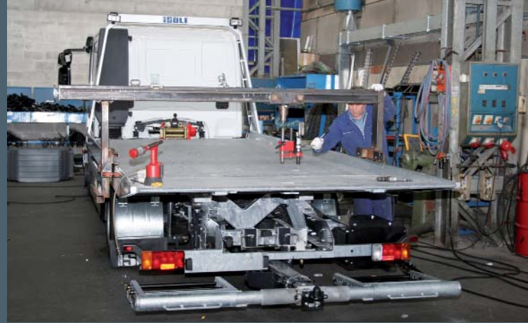
7,5 t Schiebeplateau mit Doppelkabine auf Iveco Fahrgestell mit 3,6 t Zugkraft-Winde für den VBA Mitgliedsbetrieb Gün aus Knüllwald-Remsfeld.
