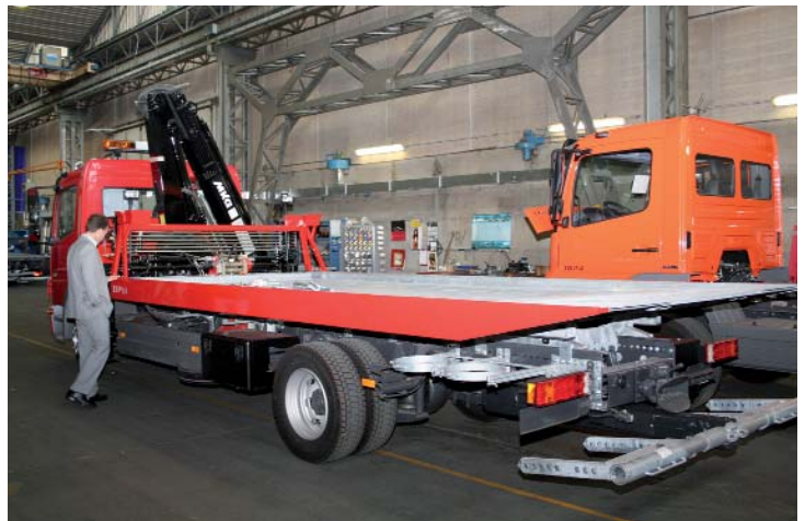
Neues Spezialbergungsfahrzeug für das VBA-Mitglied Loosen aus Frankfurt. Mercedes 1324L Bluetec - mit Aufbau Isoli slide 2D, ausgestattet mit Winde und Hubbrille.
