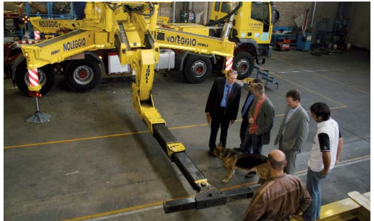
Neues Spezialbergungsfahrzeug für das VBA-Mitglied Loosen aus Frankfurt. Mercedes 1324L Bluetec - mit Aufbau Isoli slide 2D, ausgestattet mit Winde und Hubbrille.
